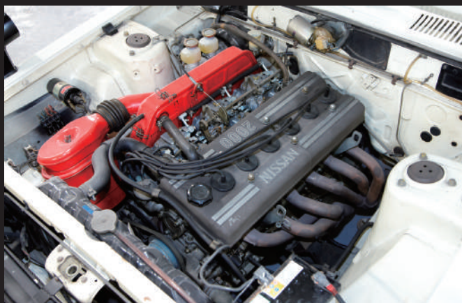
引擎室設計寬敞。採用自2000GT-R時代以來廣受好評的S20型引擎。
