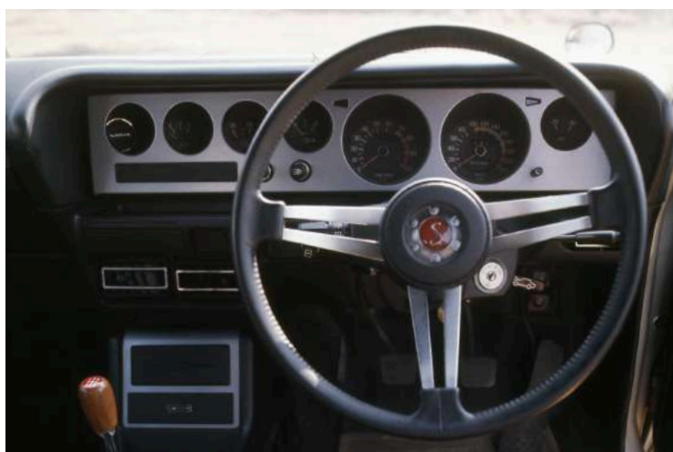
採用無反光儀錶，開關裝置安裝在方向盤柱上，以便在繫好安全帶時也易於操作。
