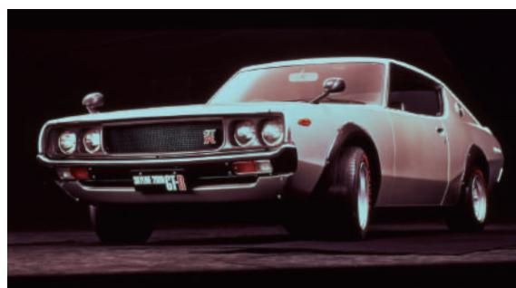
前一代車型採用分割式前進氣格柵，但KPGC110型改成增強冷卻風導入效果的設計。
